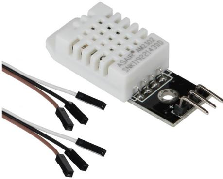
Dieser Sensor misst mittels kapazitivem Feuchtigkeitfühler und Heißleiter die Temperatur und Feuchtigkeit der umliegenden Luft und gibt die Daten über ein digitales Signal aus.
